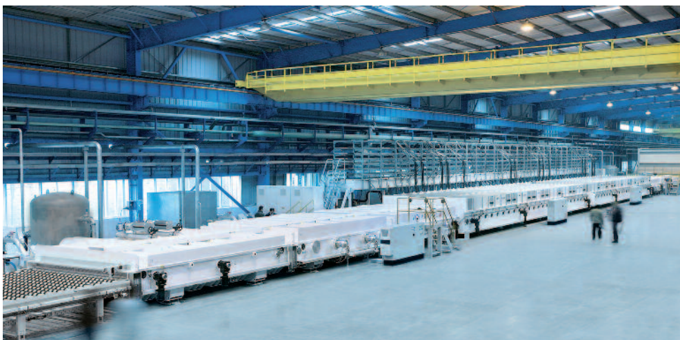
GC330H, installierte Beschichtungsanlage für Architekturglas bei einem Kunden
