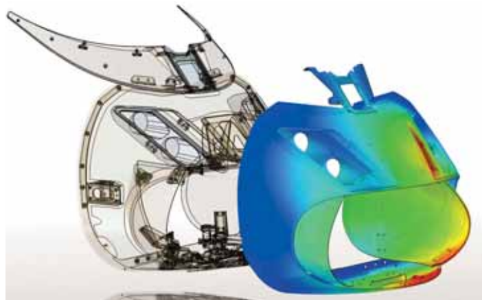
CAE (Computer-aided engineering)-Darstellung der Bugnase eines Hochgeschwindigkeitszuges mit Belastung durch den Luftstrom
